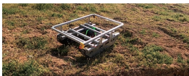
図2 果樹園用ロボットの走行ユニット
