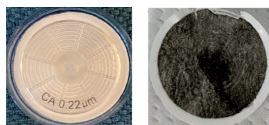
図2 プラズマ処理後のフィルターに付着した炭素 左：プラズマ処理前、右：プラズマ処理後
