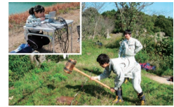
常時微動計測と表面波探査
